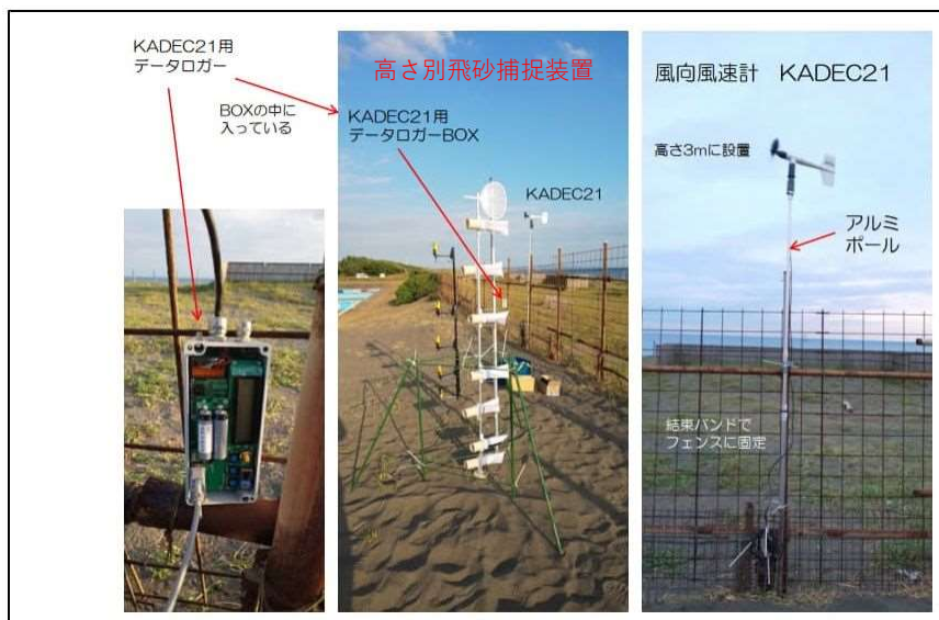
(b) 風向・風速計（定点観測用）、高さ別飛砂捕捉装置の設置状況
